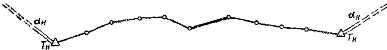
Рис. 1. Полигонометрический ход с промежуточным дирекционным углом
